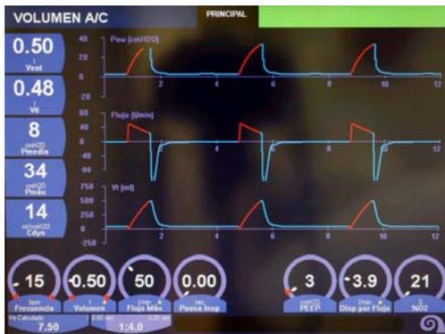
aparecen los ajustes del patrón ventilatorio disponible en cada modo. La parte central, donde se visualizan las curvas de presión, flujo y volumen, configurables por el usuario en amplitud, tiempo y posición relativa en la pantalla; y por último, la parte izquierda donde se presentan datos, respiración a respiración, de la espirometria del paciente, totalmente configurable por el usuario.
